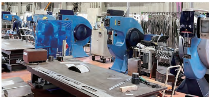
航空機の翼の成形にも使われるドイツ製三次元成形加工機。 保有台数(13台)は世界3位。
