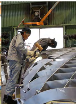
1.黄綬褒章受章者による打ち出し板金の様子。ハンドハンマーで丁寧に打つ 2.調整途中の板は、骨組に乗せて、密着度合いを確認する 3.初代0系新幹線の試作車両。振り向いている人物は山下工業所の創業者、山下清登氏(1961年日立製作所笠戸工場にて撮影)
