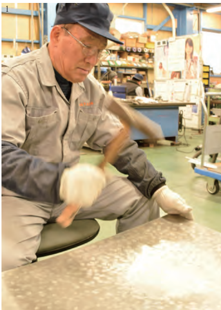
1.黄綬褒章受章者による打ち出し板金の様子。ハンドハンマーで丁寧に打つ 2.調整途中の板は、骨組に乗せて、密着度合いを確認する 3.初代0系新幹線の試作車両。振り向いている人物は山下工業所の創業者、山下清登氏(1961年日立製作所笠戸工場にて撮影)
