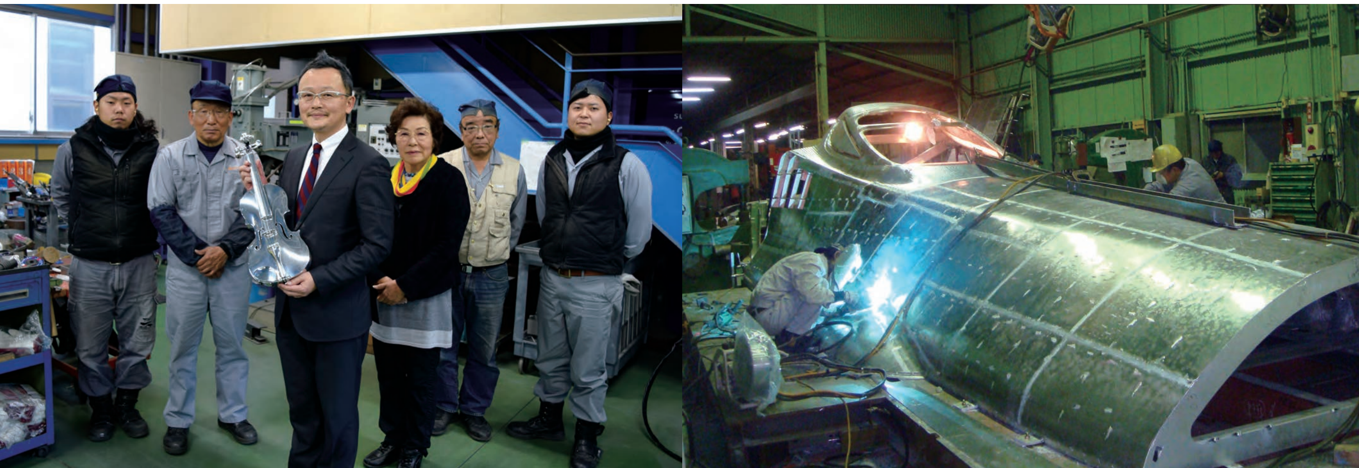
右 溶接作業中の先頭構体 左 山下さん(左から3番目)が手にするバイオリンは、新幹線と同じアルミ合金で製作したストラディバリウスのレプリカ。オックスフォード大学併設の博物館から入手した寸法測定図を基につくられた
