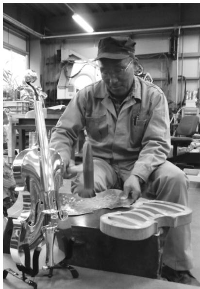
図2 現代の名工 藤井洋征氏によるバイオリン上板の打出作業風景 (山下工業所様 提供)
