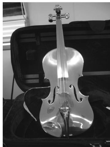
図1 アルミニウム圧延板から打出板金工法で作製されたバイオリン
