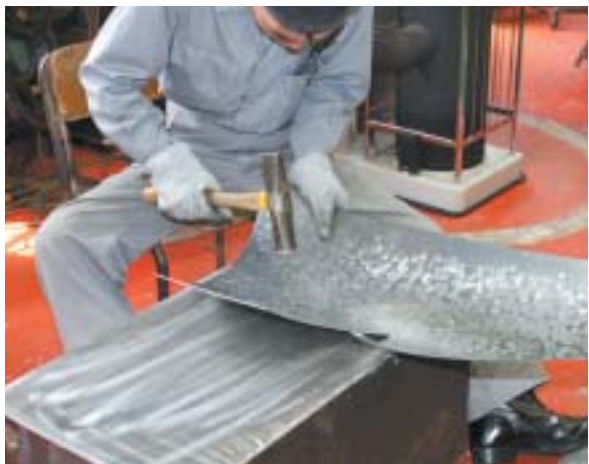
ハンマーで三次元自由曲面を作り出す打ち出し板金技術（写真提供：山下工業所）
