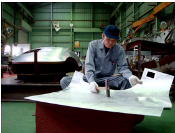
打ち出し板金
