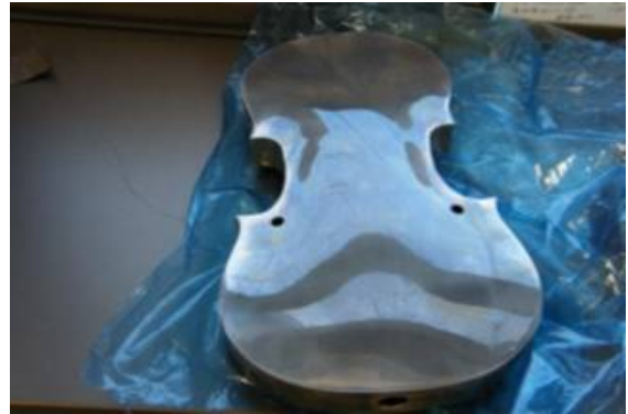
マグネシウム合金で試作したバイオリン
